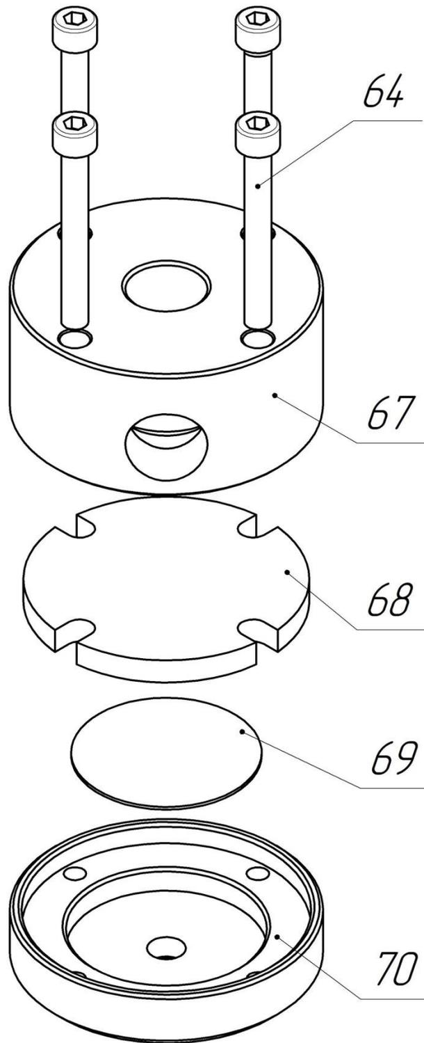
Рисунок 6.2.2 – Клапан сбросной (сборка разнесенная)
