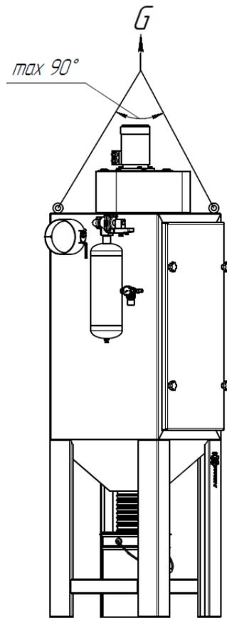
Рисунок 7.5 - Подъем и перемещение ФВУ при помощи строп
