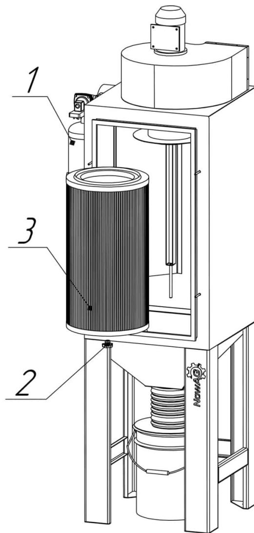
Рисунок 4.4.1 – Схема замены картриджа ФВУ
