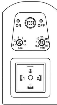
Рисунок 3.3.2 – Внешняя регулировочная панель реле времени
