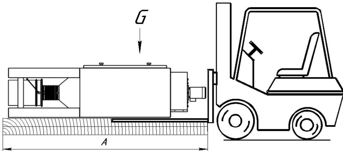
Рисунок 7.4 – Установка ФВУ на поддон
