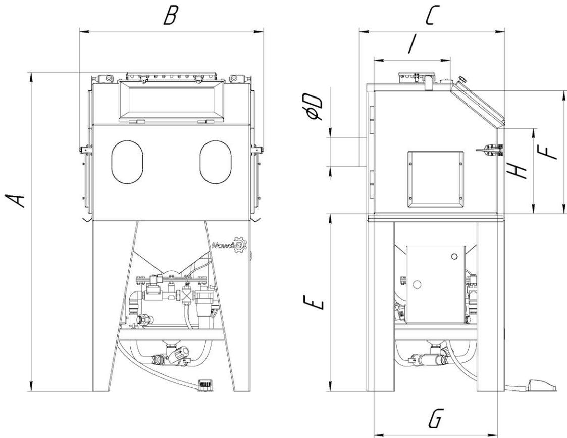
Рисунок 1.2.1 - Габаритные и присоединительные размеры камеры
