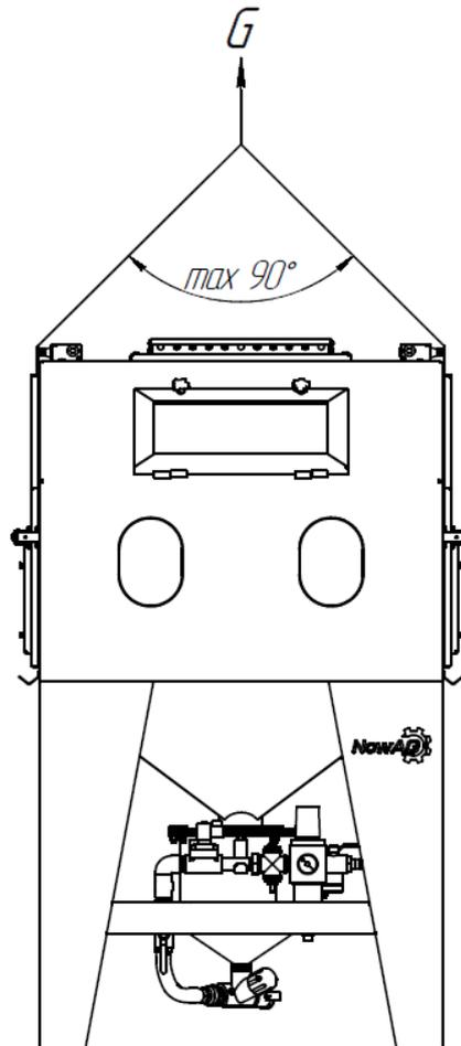
Рисунок 7.2 - Подъем и перемещение камеры при помощи строп
