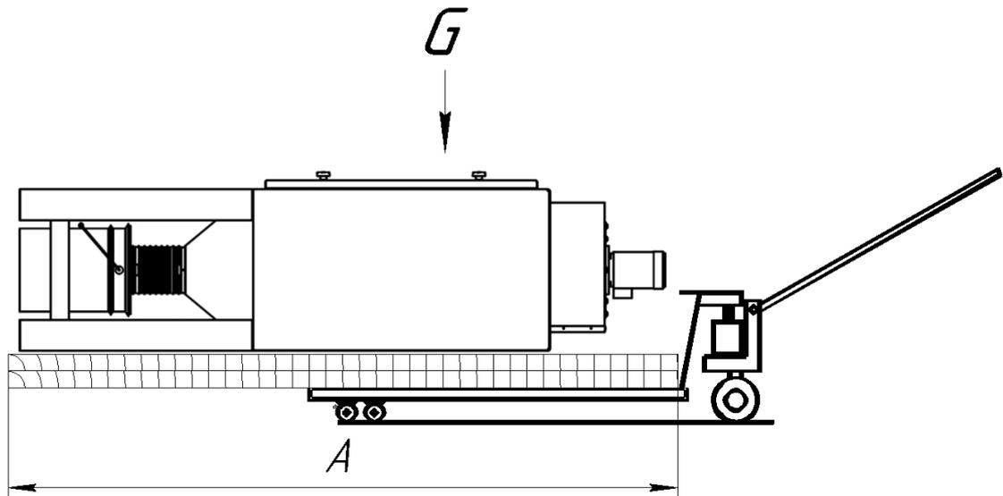
Рисунок 7.6 - Установка ФВУ на тележку гидравлическую
