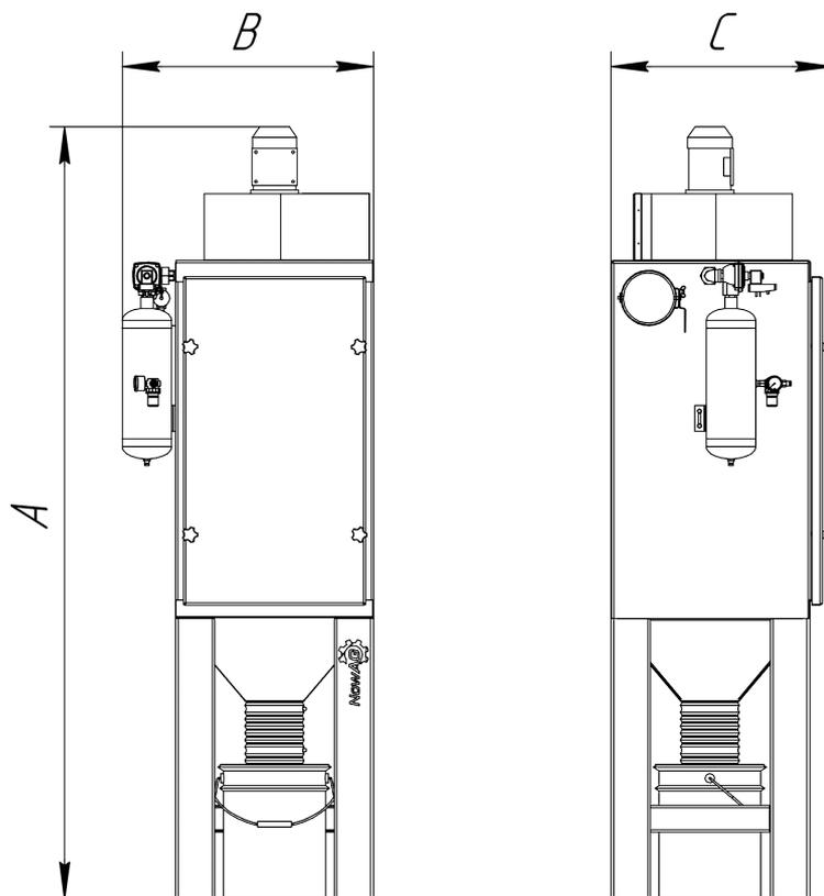
Рисунок 1.2.2. – Габаритные и присоединительные размеры ФВУ
