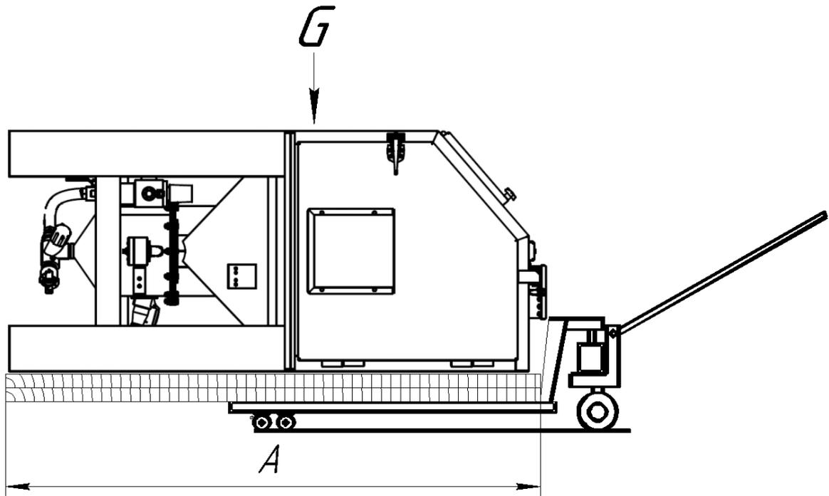
Рисунок 7.3 - Установка камеры на тележку гидравлическую
