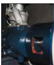
Электродвигатель и винтовой блок соединены между собой кулачковой муфтой и врачаются с одинаковой скоростью 2980 об/мин.
