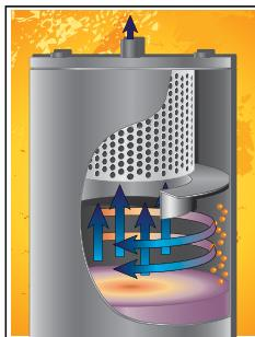
Компрессоры AirStation® оснащены эффективной трёхступенчатой системой сепарации. Большая часть масла отделяется центробежной силой в баке сепаратора.
