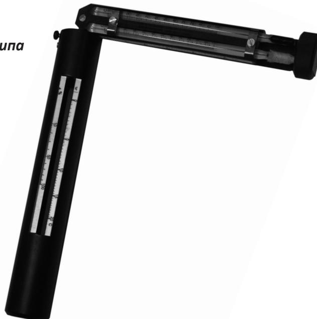
Затем быстро считать показания «мокрого», затем «сухого» термометров, вставить корпус в кожух и по шкалам, нанесенным на кожухе, определить влажность воздуха и значение точки росы.
