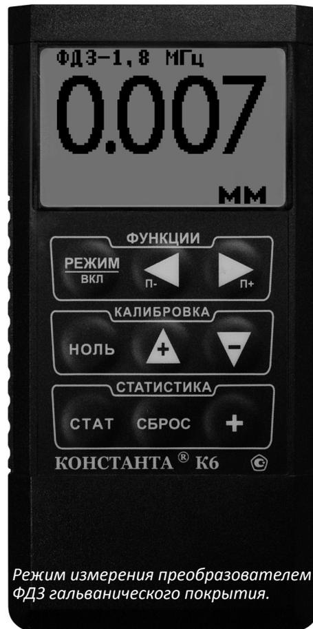
Режим измерения преобразователем ФДЗ гальванического покрытия.
