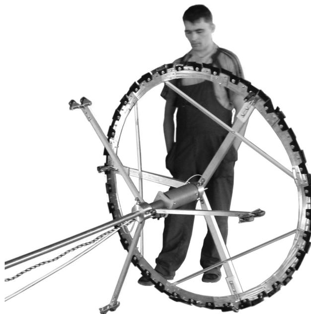
Внутритрубный дисковый электрод на диаметр трубы  $\varnothing 1420$  мм.
