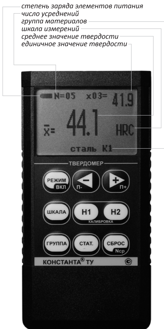
клавиатура прибора организована по принципу «Одна кнопка - одна функция»
