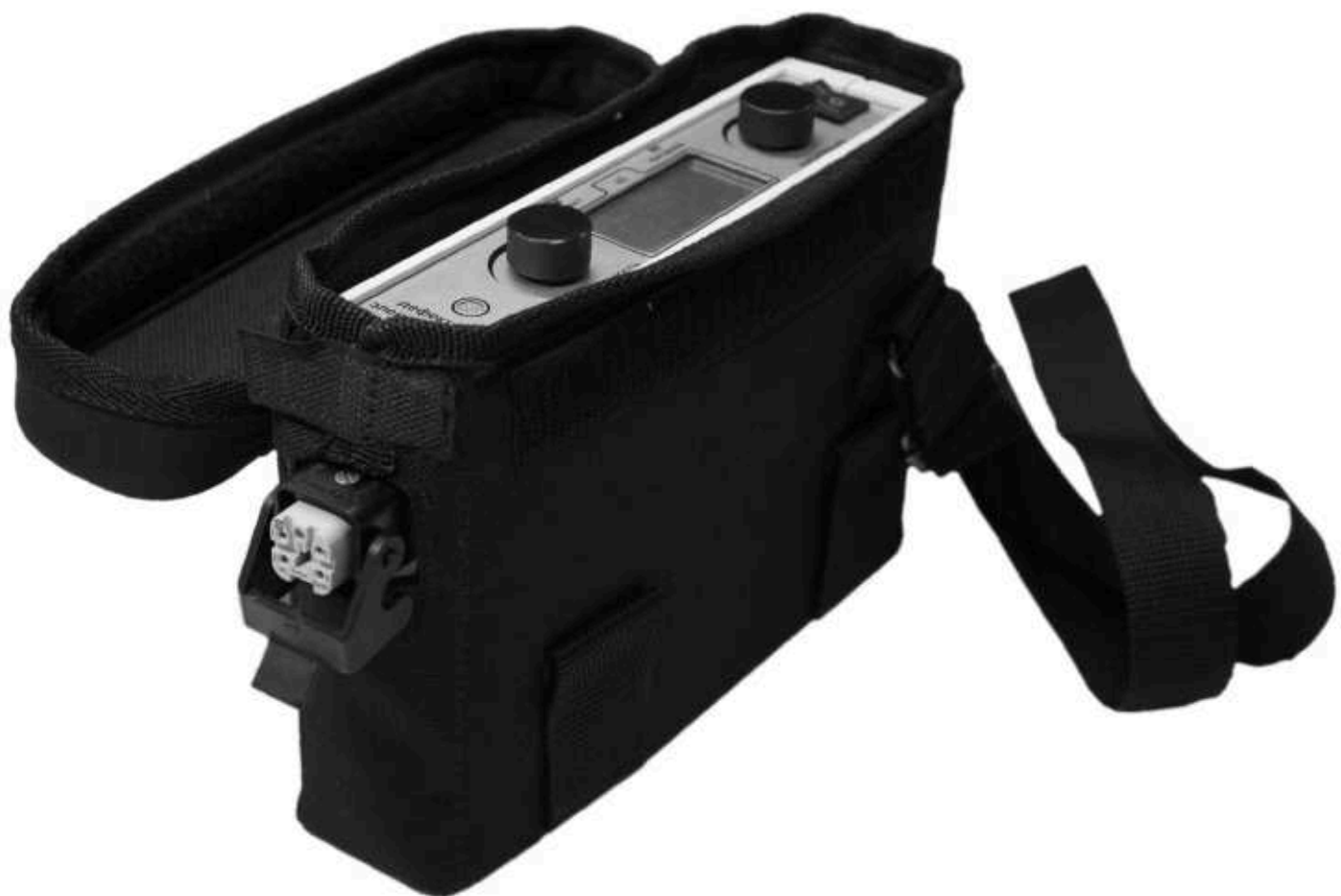
Рис. 6. Электроискровой дефектоскоп «Корона» в термосумке.
