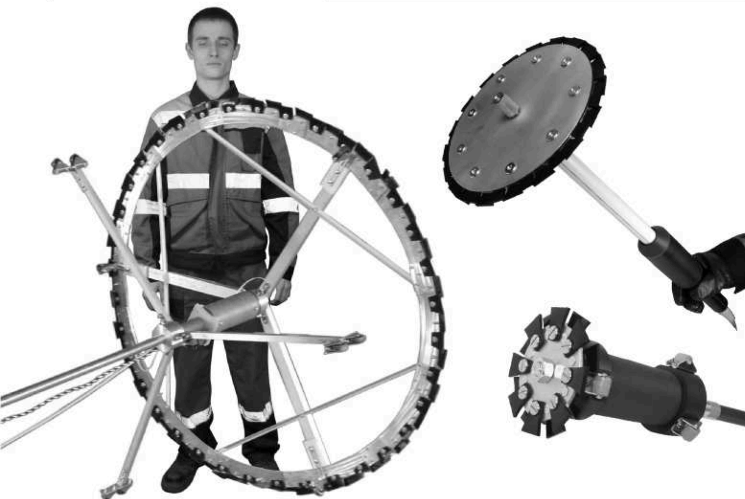
Рис. 10. Стандартные и специализированные электроды для контроля внутренних покрытий труб.
