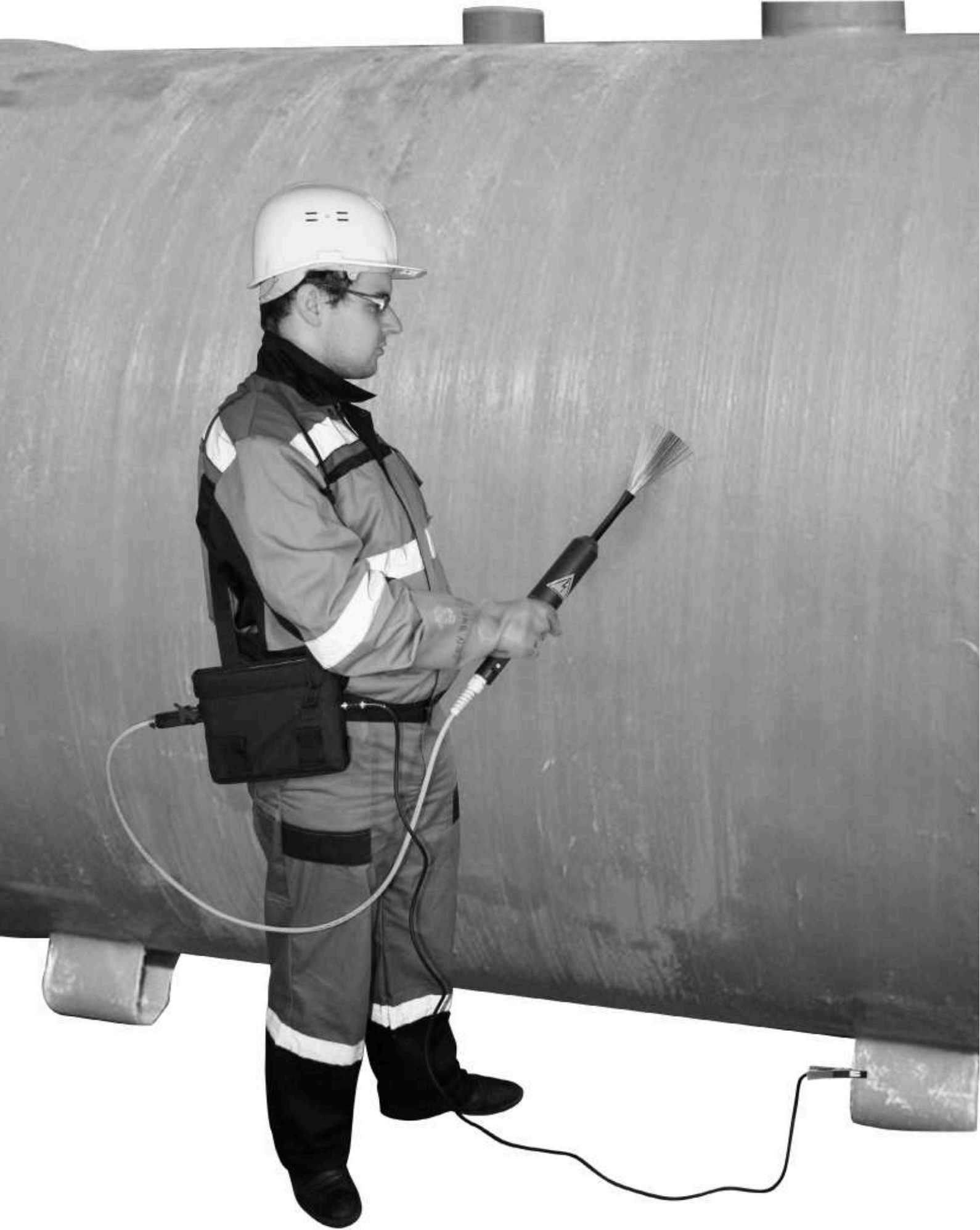
Рис. 3. Проведение контроля покрытия с использованием электроискрового дефектоскопа.
