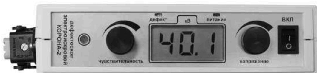
Рис. 5. Индикатор электроискрового дефектоскопа «Корона».
