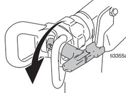
1 Отпустите курок распылителя и поставьте его на предохранитель. Проверните наконечник SwitchTip. Снимите курок распылителя с предохранителя, и нажмите на курок, чтобы для удаления засорения. Никогда не направляйте пистолет-распылитель на свою руку или в тряпку!
