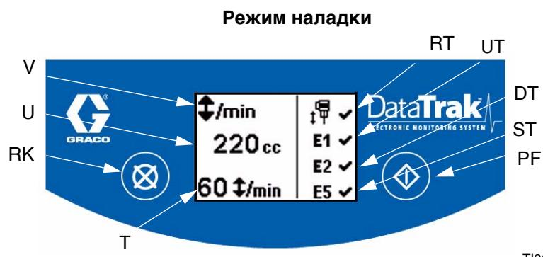
Рис. 5. Элементы управления и индикаторы DataTrak
