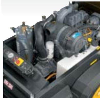
**Новый винтовой компрессорный элемент Atlas Copco C111** отличает увеличенные поперечные размеры роторов. Это позволило снизить частоту вращения, что увеличило ресурс до 40 тыс. моточасов до капремонта. Новый профиль компрессорного элемента имеет более высокий КПД, что позволило снизить удельный расход топлива. Минимальный вынос компрессорного масла позволяет не доливать его в течение одного года эксплуатации.
