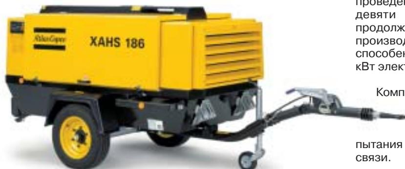
Компрессоры **XAS 136** и **XAS 186** предназначены для проведения работ, где требуется одновременное подключение до девяти отбойных молотков. Они также рассчитаны на продолжительные работы с пескоструйными аппаратами высокой производительности и бетононасосами. Компрессор **XAS136DdG** способен одновременно поставлять как сжатый воздух, так и 9,6 кВт электроэнергии.
