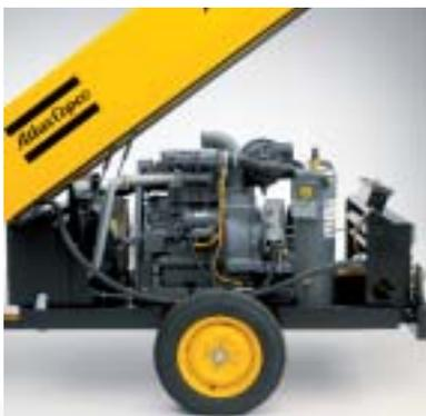
Новая конструкция кожуха и съемные боковые панели обеспечивают моментальный доступ к любой точке установки.
