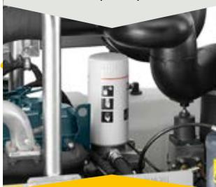
Закручиваемый фильтр компрессорного масла с хорошим доступом
