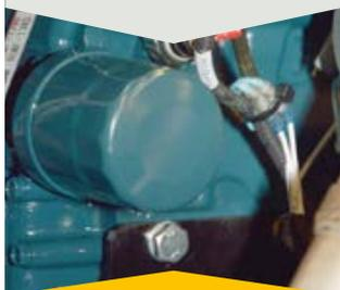
Закручиваемый фильтр моторного масла с хорошим доступом
